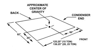
**FIGURE 2 - CENTER OF GRAVITY**
